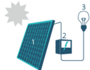
1. Zonnepaneel | 2. Omvormer | 3. Elektrische toestellen
